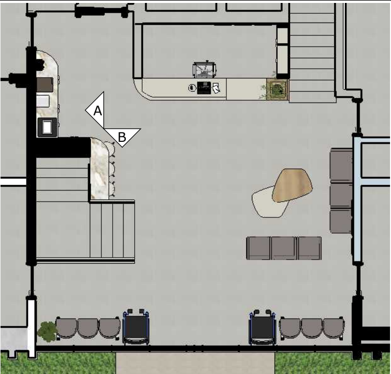
PLANTA BAIXA - RECEPÇÃO ESCALA - 1:100
